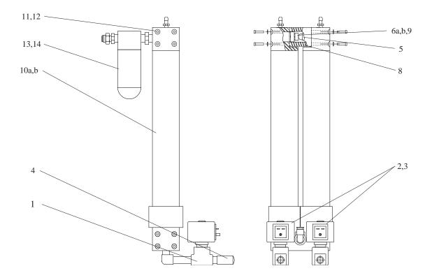
**Figure 10** DRY-PAK<sup>®</sup> **Assembly**
