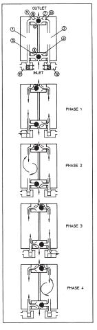
Figure 3 DRY-PAK<sup>®</sup> Cycle
